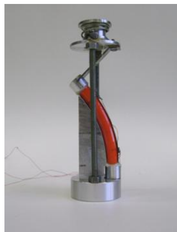
Рис. 5. Схема и внешний вид установки для измерения остаточных деформаций кабеля
