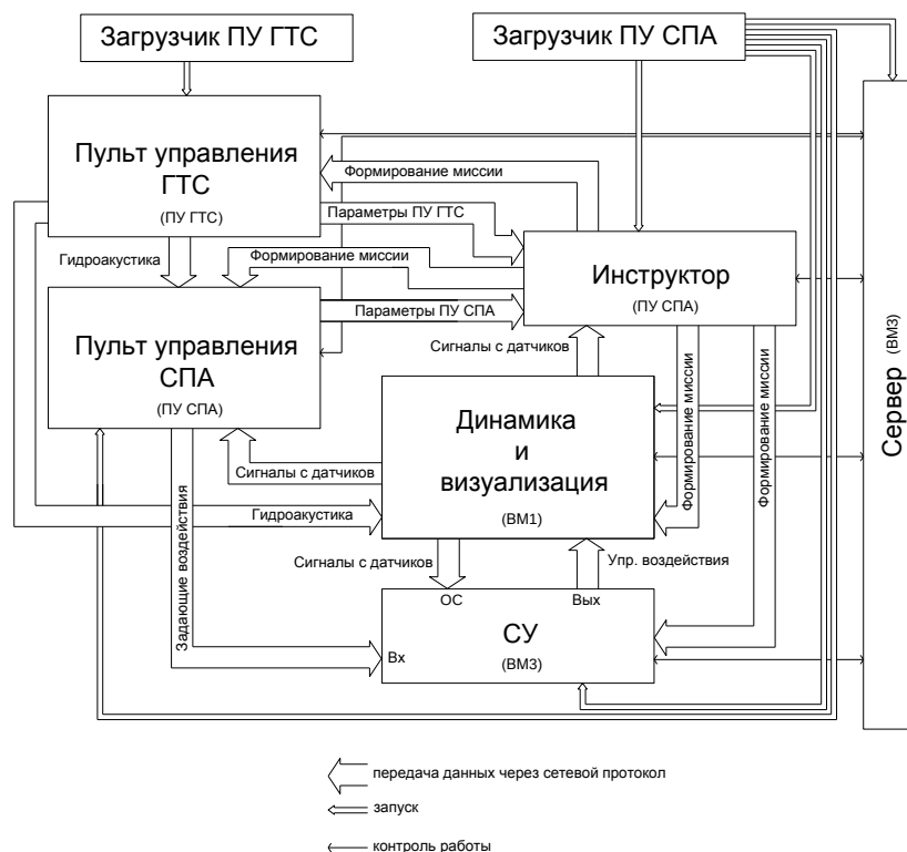
Рис. 2. Схема взаимодействия программ ТК
