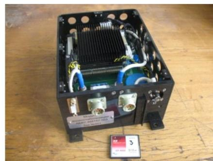
**Рис. 7.** Вычислительный модуль системы видеостабилизации
