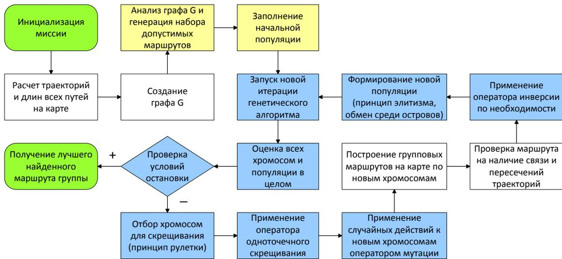
Рис. 4. Блок-схема работы модуля планирования маршрутов на основе ГА
